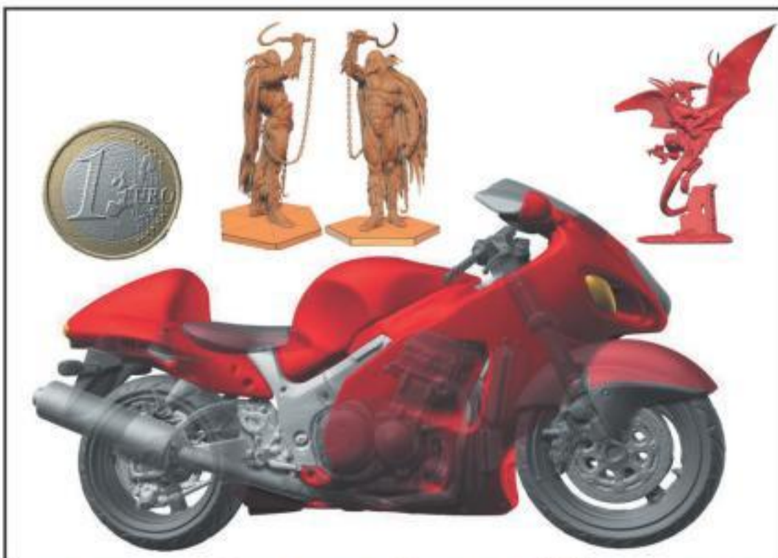
Пример трехмерного объекта, полученный при помощи DAVID-laserscanner . Сложные объекты придется дорабатывать в редакторе.
