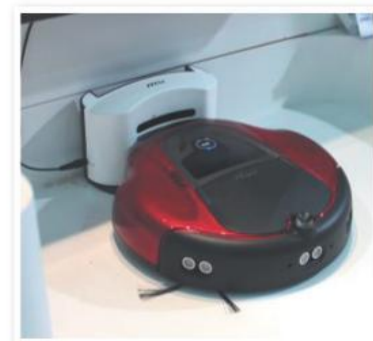
Робот-пылесос от MSI: ультразвуковой сонар для обхода препятствий, возможность возвращаться на док-станцию для подзарядки, на старшей модели — даже видекамера и связь с интернетом.
